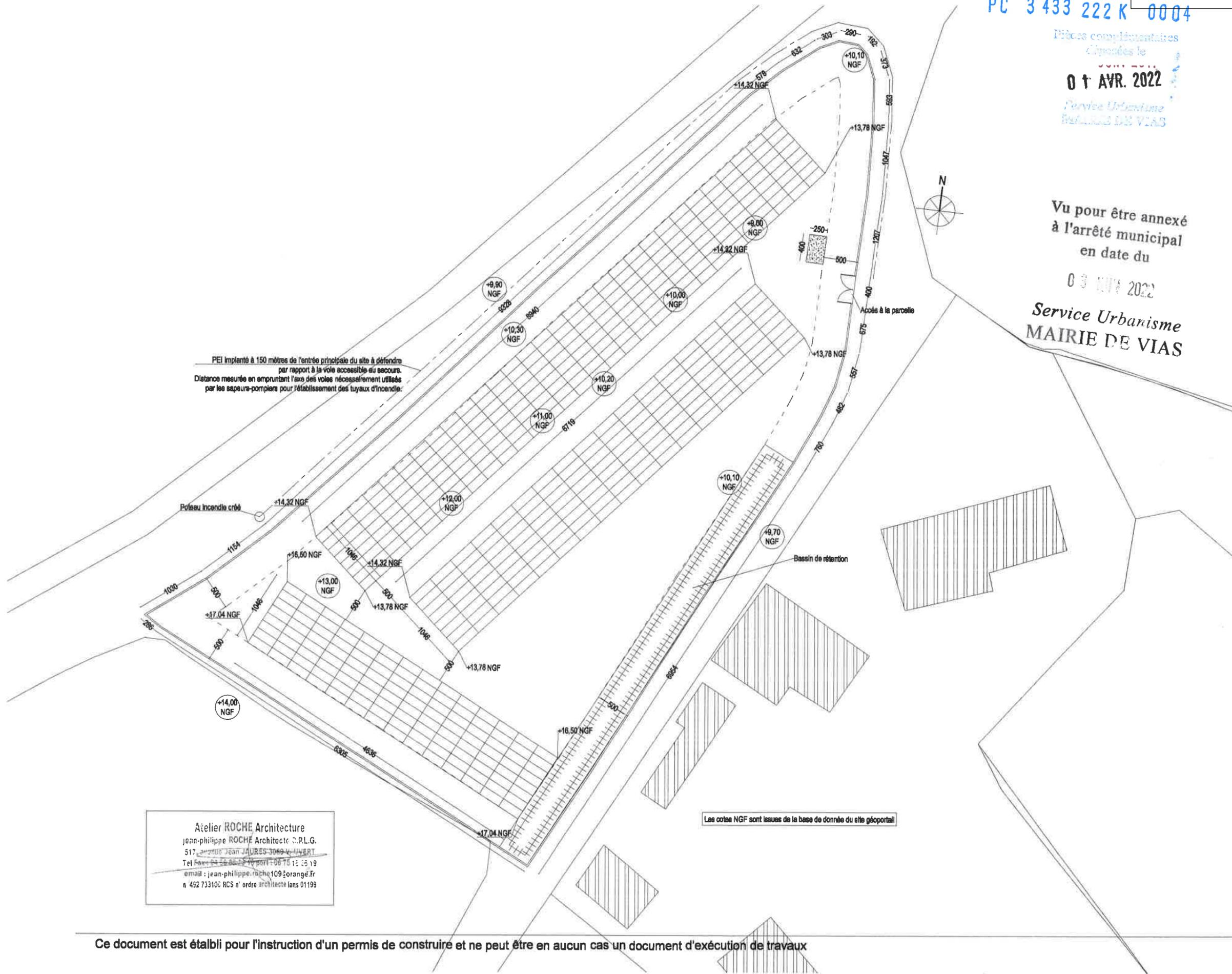
PEI implanté à 150 mètres de l'entrée principale du site à défendre par rapport à la voie accessible au secours. Distance mesurée en empruntant l'axe des voies nécessairement utilisés par les sapeurs-pompiers pour l'établissement des tuyaux d'incendie.
