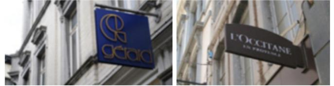
**La largeur maximale autorisée est 70 cm**, la surface est inférieure à 0,5 m<sup>2</sup> hors attaches, et son épaisseur réduite au maximum (tôle découpée, fer forgé, caisson opaque) pour ne pas gêner la vue de la façade.
